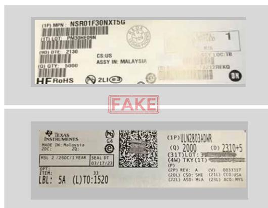
**二级拦截：**按照 IDEA-STD-1010B 检测标准，通过外观、印字、尺寸显微镜检测和丙酮和刮擦测试等进行检验，针对本体出现氧化、划痕、二次涂层、漏铜等现象进行二次拦截
